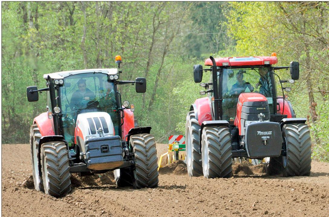
Eco-Drive umfasst nicht nur Fahren im optimalen Drehzahlbereich. Dazu gehört auch die richtige Einstellung der Anbaugeräte und eine angepasste Fahrzeugballastierung. (Bild: zvg)
