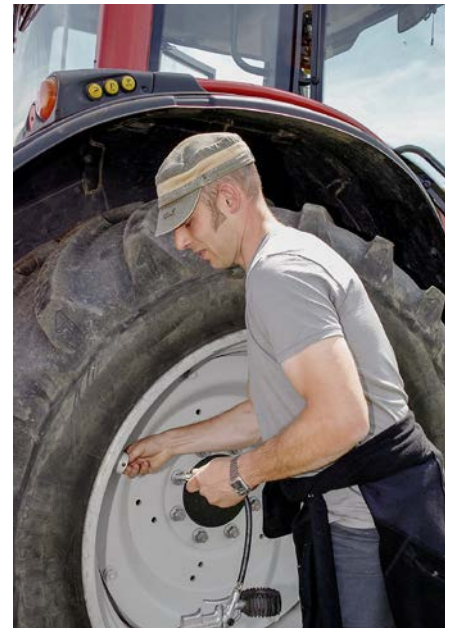
Réduire la pression des pneus au minimum dans les champs influe positivement sur la consommation de carburant et la compaction.
