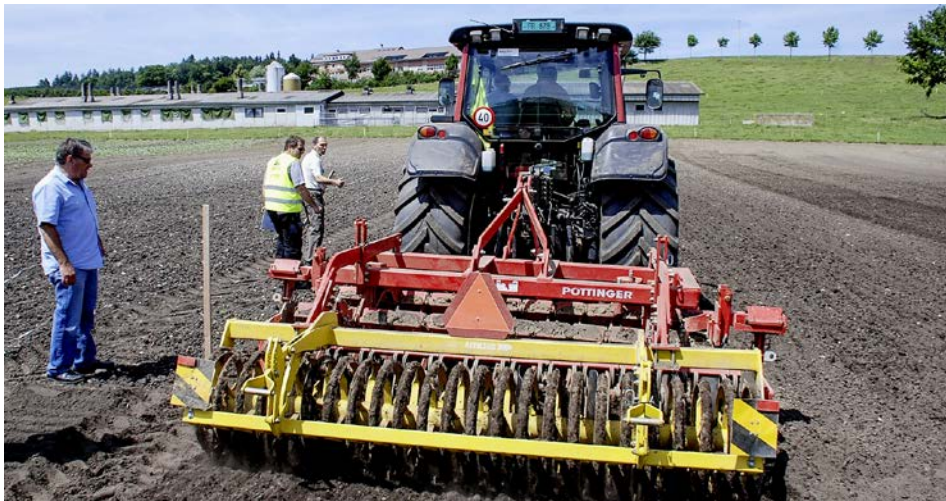
Les participants mesurent le patinage avec une déchaumeuse sur une distance de référence. Constat: la force de traction augmente et le patinage diminue quand la puissance de traction reste constante. (Photos: Dominik Senn)
